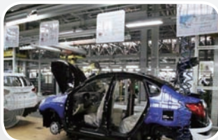
正在安装座椅
